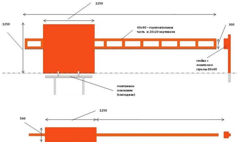
**Назначение:** шлагбаум предназначен для перекрытия проездов шириной от 2500 до 6000мм. Шлагбаум может использоваться в ручном и автоматическом режиме.
